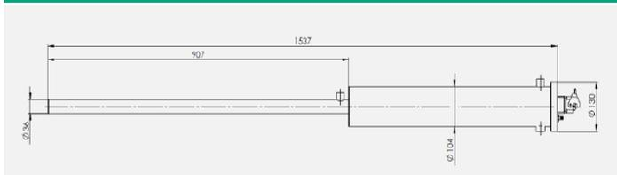
尺寸图 (PYROINC 768N endoscope)
