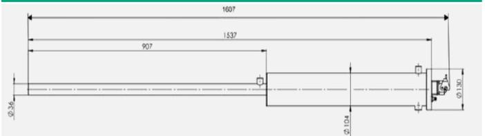
尺寸图 (PYROINC 1920/1600N endoscope)
